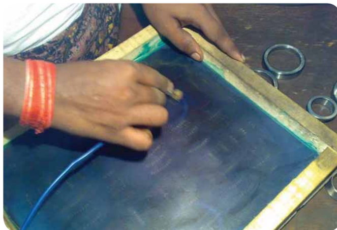
Фальшивая маркировка гравировается на подшипниках при помощи шелковых экранов наподобие этого.
